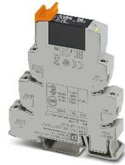
Módulo de relés de estado sólido con punto de embornaje libre de potencial adicional, salida AC máx. 2 A
