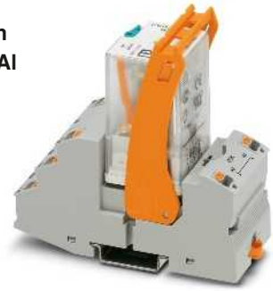
Módulo de relés octales de 2 contactos conmutados con conexión push-in y accionamiento manual
