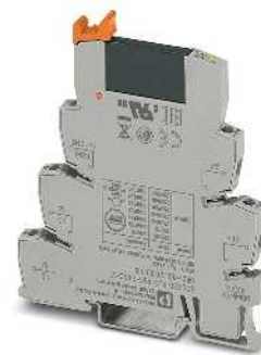
Módulo de relés de estado sólido, salida DC máx. 100 mA
