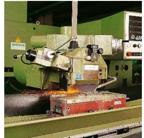
Protección contra bloqueo y rotura de herramientas, umbral de advertencia antes del desgaste de la herramienta y del cojinete.
